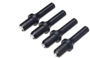
直头铆壳 全长：2-1/2"，柄部直径0.401" 适用铆钉：AN470、MS20470、NASMM20470
