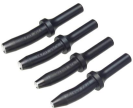
10°弯头铆壳 全长：3-1/2"，柄部直径0.401" 适用铆钉：AN470、MS20470、NASMM2047
