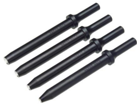
直头铆壳 全长：5-1/2"，柄部直径0.401" 适用铆钉：AN470、MS20470、NASMM2047
