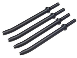
10°弯头铆壳 全长：7-1/2"，柄部直径0.401" 适用铆钉：AN470、MS20470、NASMM2047
