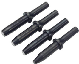
直头铆壳 全长：3-1/2"，柄部直径0.401" 适用铆钉：AN470、MS20470、NASMM2047
